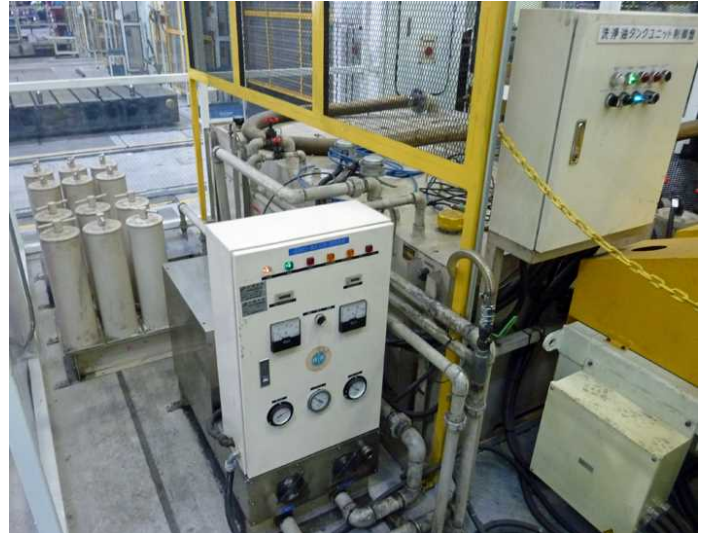
↑自動車ボディプレス機鋼板洗浄機に接続された ミラクルボーイ SRC-8112-350V型
