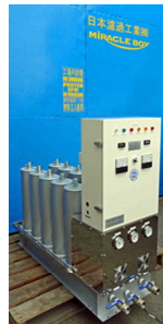
↑主機 油タンクのとりに 油濾過器が置かれています
