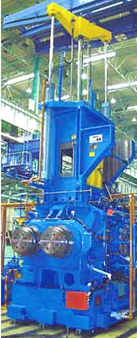
↑ 原料ゴムに補強材のカーボンブラックなどを分散させる混練機
